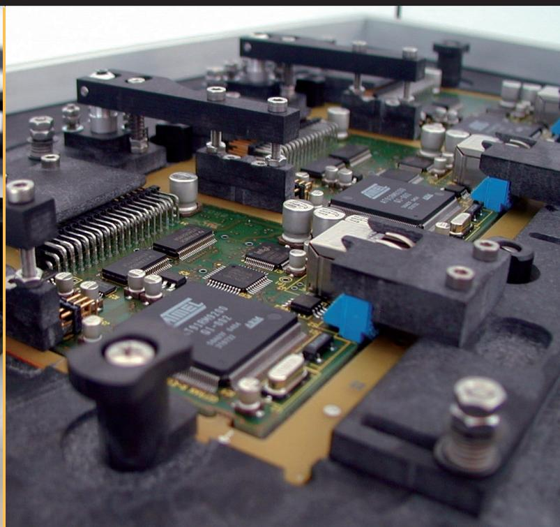
**Productos fabricados en composite Durostone<sup>®</sup>, material de altas prestaciones y excelentes propiedades mecánicas, térmicas y antiestáticas. Permite soldadura selectiva de PCB complejos en su diseño y forma (Montaje convencional y SMD).**
